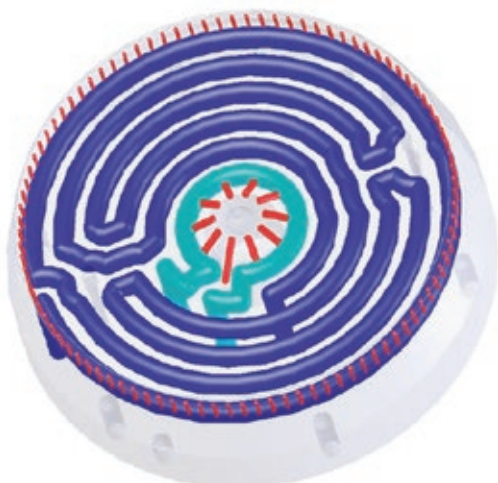
» Slika 6.: Kalupni vložek na brizgalni strani za tankostenski embalažni del z dvema neodvisnima hladilnima krogotokoma. Vir: Contura MTC
